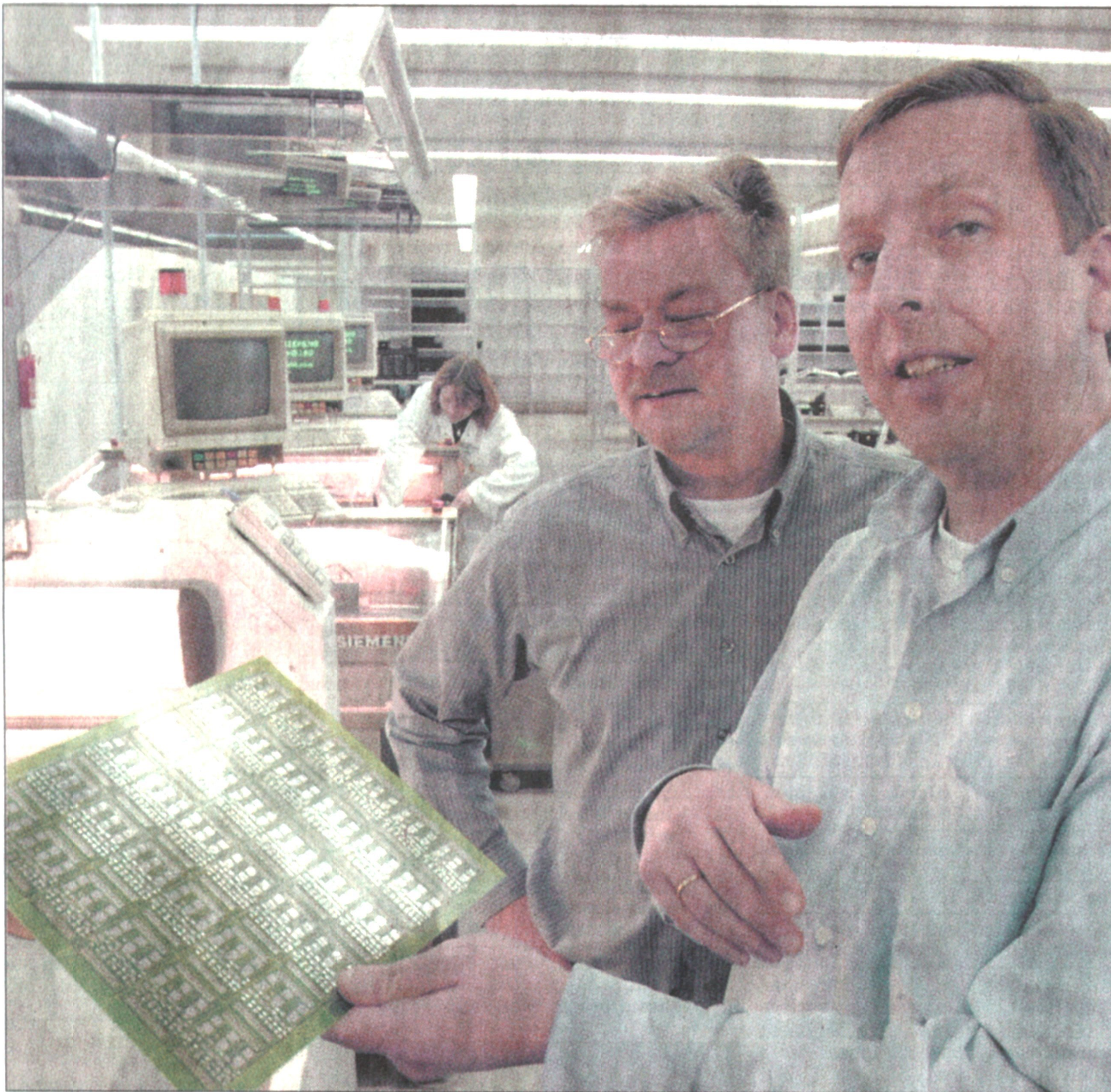
Torsten Mohrholz (l.) und Steffen Friedemann erläutern, wie eine Leiterplatte zum so genannten Pastendruck vorbereitet wird. Anschließend erfolgt die maschinelle Bestückung mit den elektronischen Bauteilen.
